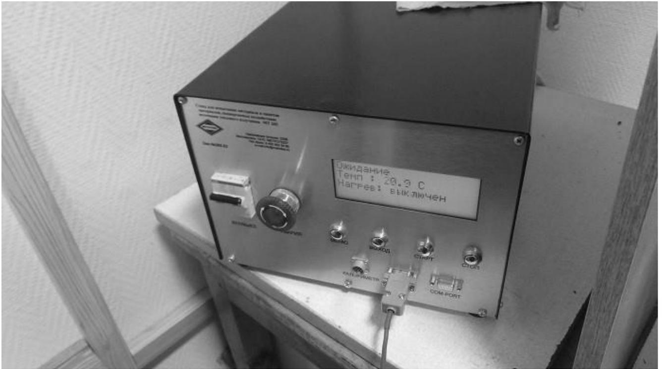
Рис. 3. Измерительный блок станда Метротекс МТ 265
